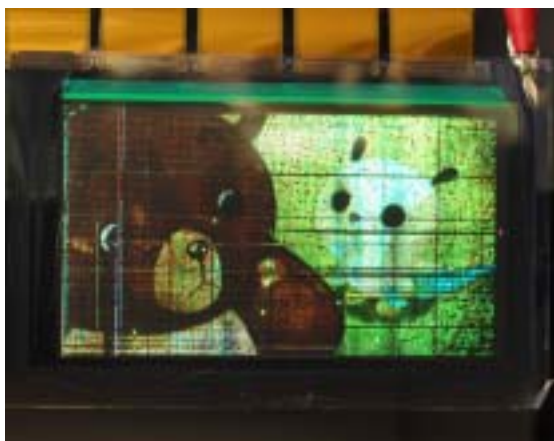
図 5. 当所で試作した 6 インチフレキシブル有機 TFT 駆動 EL ディスプレイ
