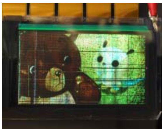
図 5. 当所で試作した 6 インチフレキシブル有機 TFT 駆動 EL ディスプレイ
